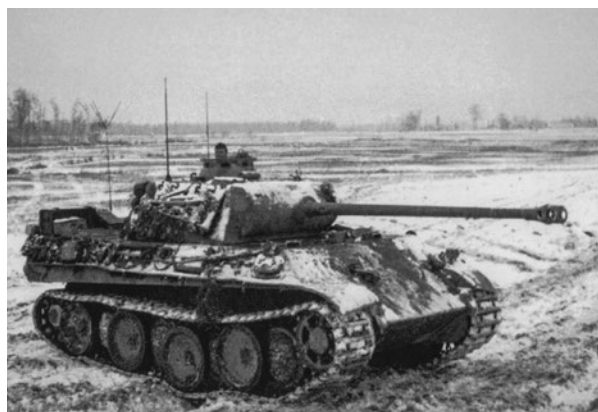
Tank Panther na širých pláních Východního Pruska. Všechny tři antény jsou umístěny podle předpisu, věž je kolem dokola ověšena články řetězů. Tento způsob zesílení tanku byl oficiálně zakázán. Ale jako mnohé jiné zákazy byl i tento ignorován. (Anderson)
